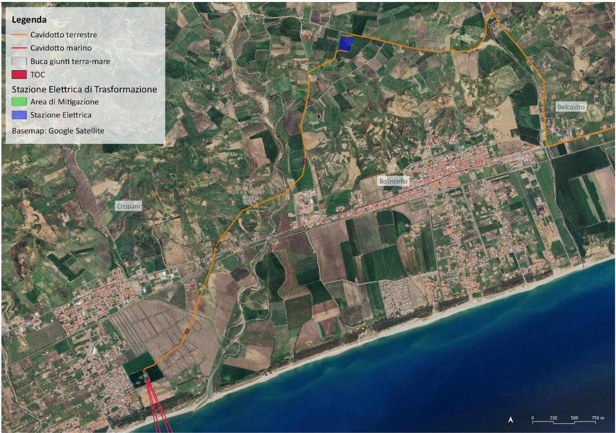
**Figura 2-10: Percorso del cavidotto onshore dal giunto di transizione terra-mare alla SE di Trasformazione.**
