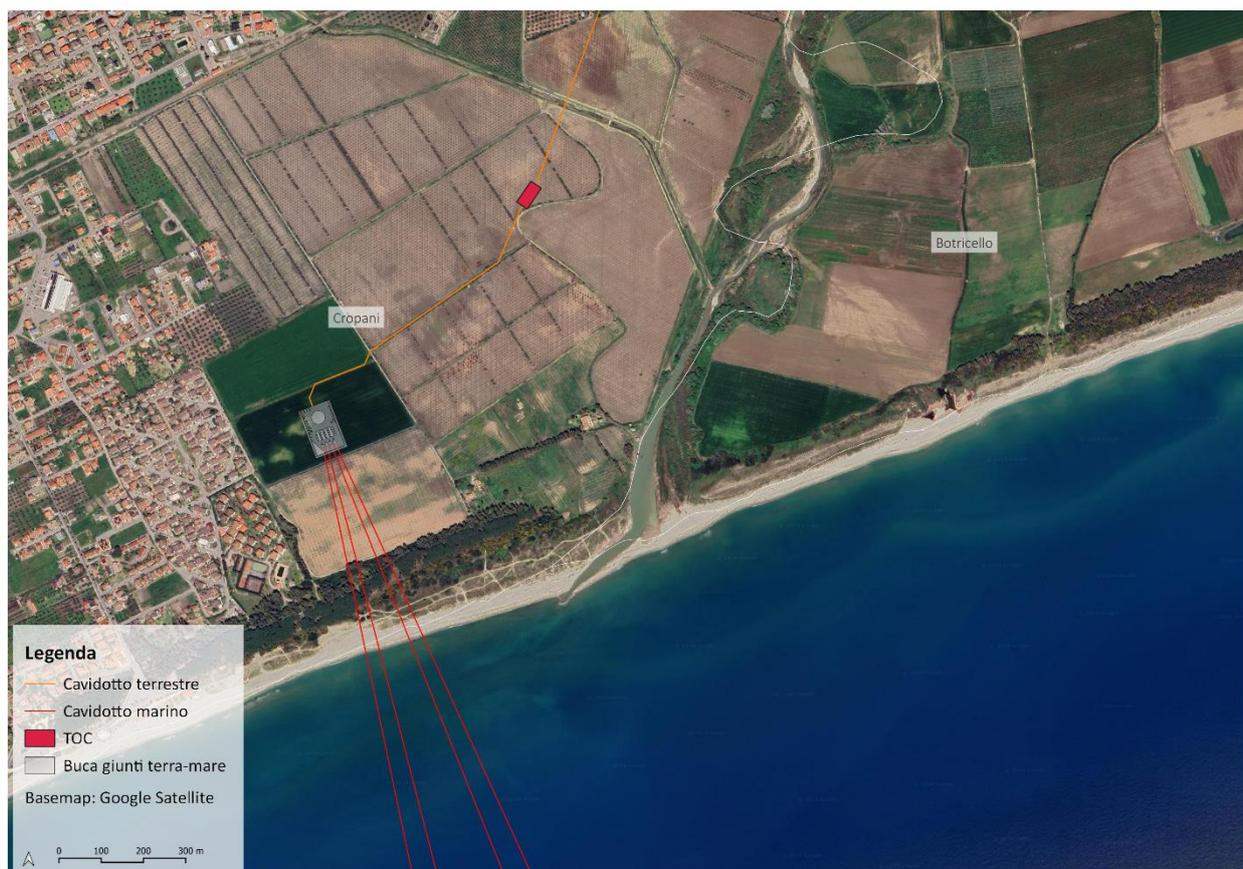
**Figura 2-3: Inquadramento su ortofoto giunto di transizione terra mare e primo tratto di cavidotto onshore.**
